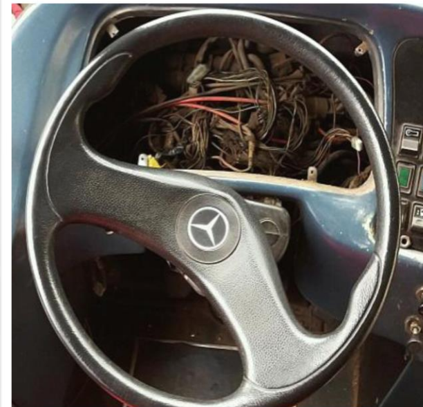
ÔNIBUS SEM TACÓGRAFO E COM FIOS EXPOSTOS
